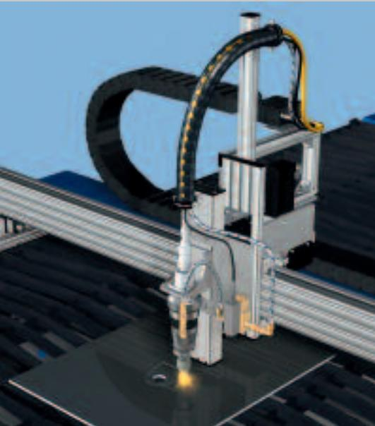
Der Laserstrahl wird vom Resonator bis zum Bearbeitungskopf in einer Glasfaser geführt.
